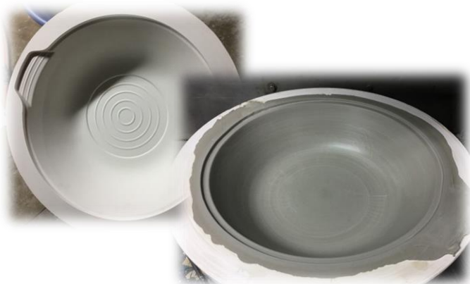
修坯後之輕質化耐熱震陶瓷炒鍋
